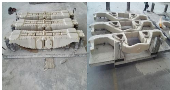
图 1 某铁路机车厂芯子
