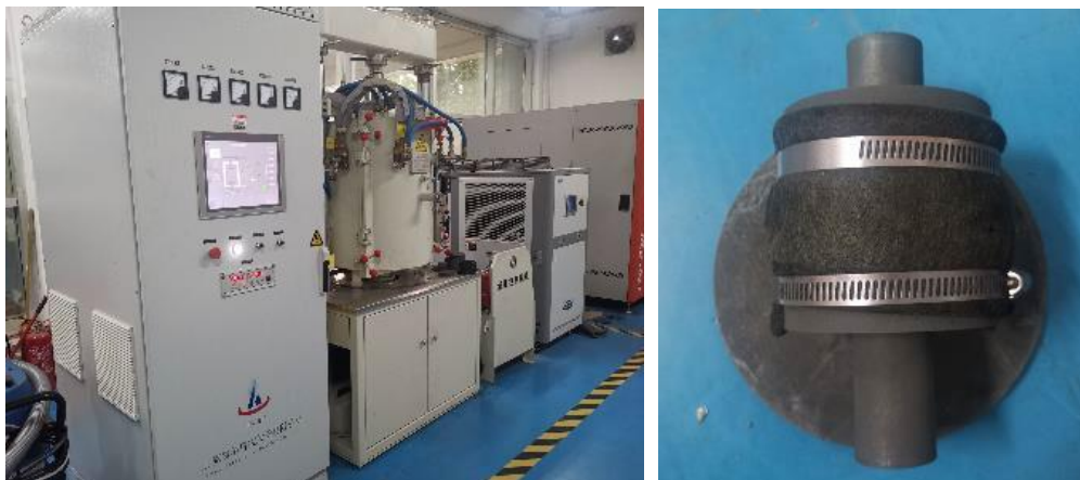
图 2 真空热压烧结炉和模具实物图 (a) 真空热压烧结炉实物图 (b) 模具实物图
