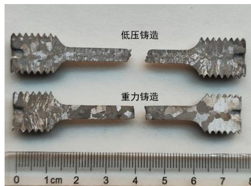
图 3-4 低压铸造和重力铸造的试棒宏观晶粒度 [26]
