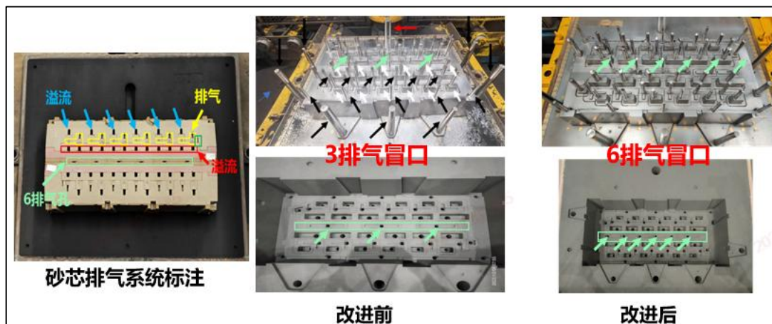
图 2 某系列缸盖排气冒口改进前后示意图
