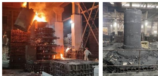
(c) Pouring (d) Unboxing and cleaning
